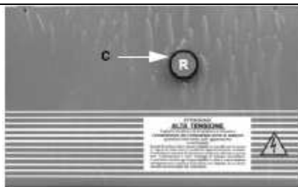
Pulsante sblocco apparecchiatura su bruciatori PN30 e PN60
