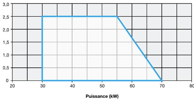
Contre-pression dans la chambre de combustion (mbar)
