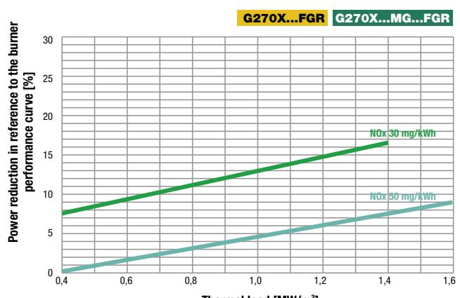
\* According to UNI EN 676 correction method; p amb 1013 mbar; t amb 20°C; h 10 g/kg.
